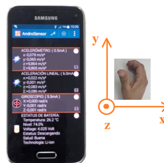
FIGURA 1. A la izquierda un smartphone y a la izquierda se muestra como se designan las direcciones y sentidos de los ejes cartesianos asociados a las magnitudes vectoriales que le es posible medir con Apps adecuadas.
